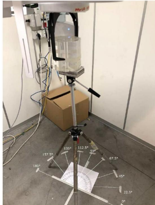
CEPH modunda başıboş radyasyon ölçümleri için deneysel ayarlar.
